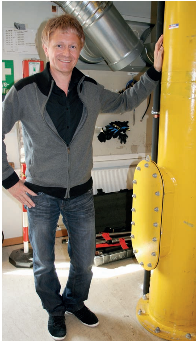
Her er den midterste delen av den nye, innendørs testbrønnen. Luken gjør det mulig å koble til og simulere ulike tilstander og hendelser som ultralydutstyret skal ta bilde av.
